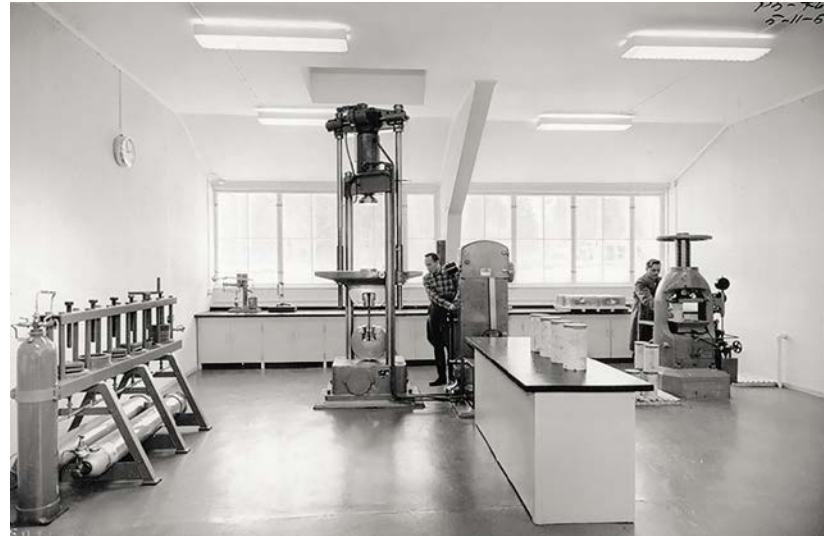
Uudet tutkimustilat olivat väljät ja siistit. Huippututkimukselle oli hyvät edellytykset. Oikealla betonin lujuusmittauksia tekevä puristin ja keskellä teräksien vetolujuutta mittaava koje. Kuva: Fortum Oyj:n arkisto
