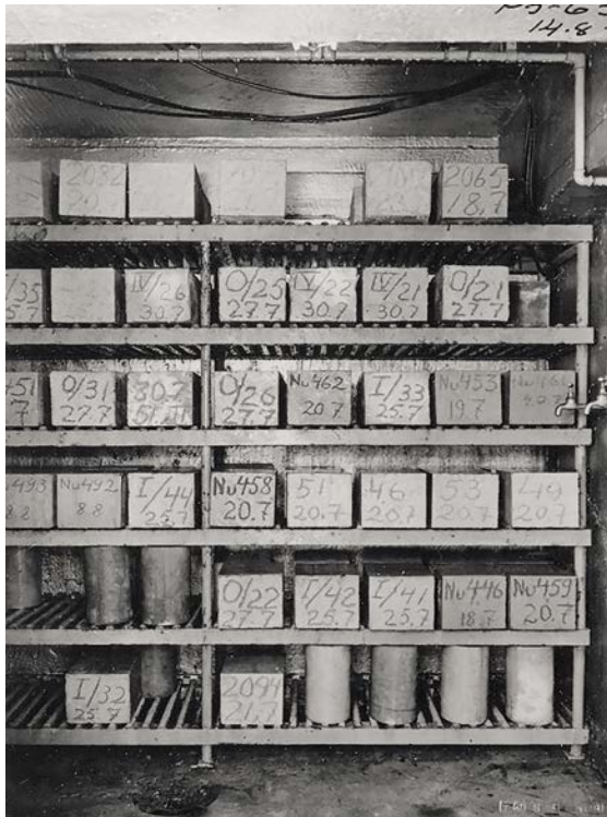
Koenäytteitä -betonikuutiota ja -lieriöitä- säilytettiin halutuissa olosuhteissa, kunnes tulokset oli saatu koottua. Kuva: Fortum Oyj:n arkisto
