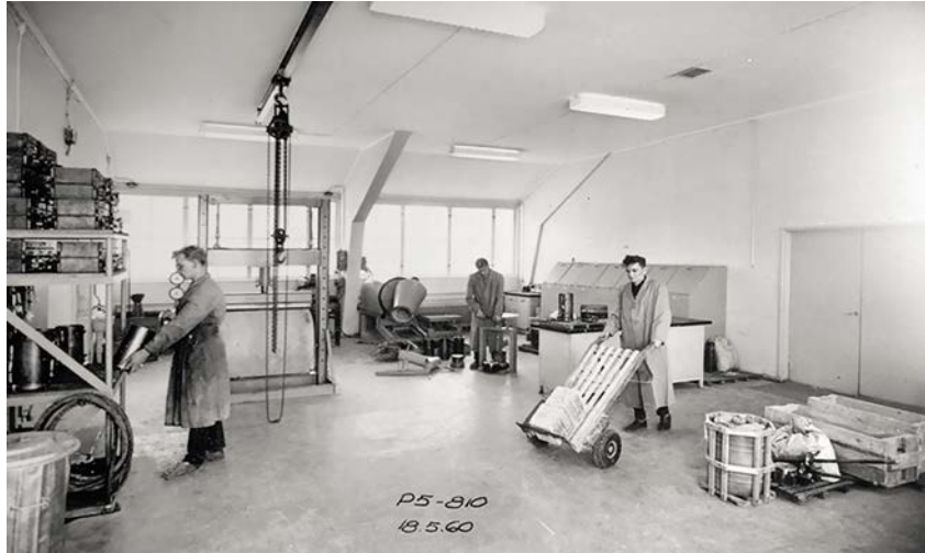
Betonihuoneessa valmistettiin koekuutiota ja -kartiota sekä testattiin ojarumpuelementtien kestoja. Koekappaleet koodattiin ja numeroitiin tarkasti ja varastoitiin. Kuva: Fortum Oyj:n arkisto.
